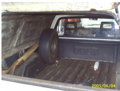
Interior da carroceria da Pampa com revestimento em fibra bastante danificado, estepe junto dos r.s.s e ferramental impróprio para esta operação.
