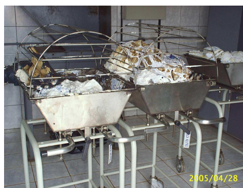
Resíduos pós-tratamento, aguardando para a fase final de trituração e posteriormente encaminhados para o aterro sanitário
