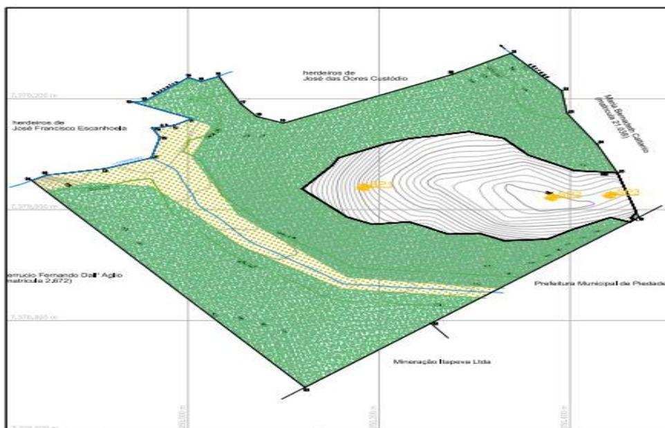
Figura 55. Localização dos pontos de sondagem e percussão na área do novo aterro. Fonte: Adaptado da sondagem do Grupo Ortega.
