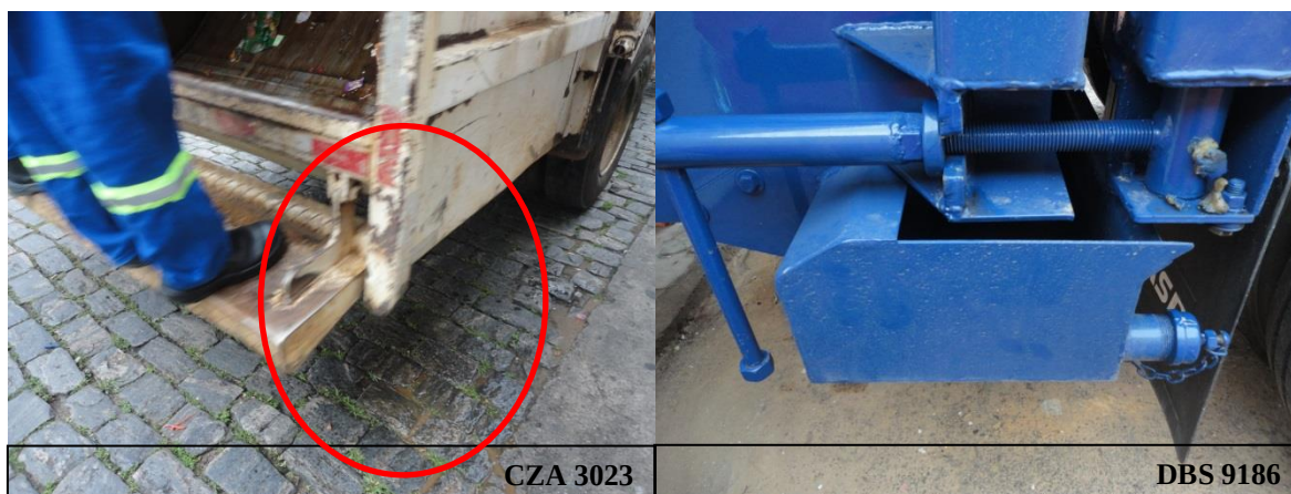
FIGURA 02 – Sistema de armazenamento de chorume do caminhão coletador
