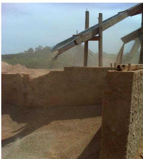
**Foto 4.21 - Separação dos Produtos Finais a partir dos Resíduos Sólidos de Construção Civil, na BMS**
