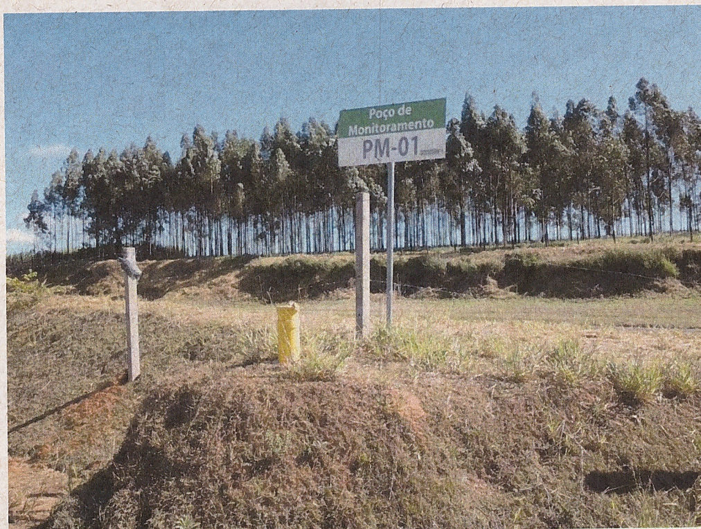
Poço de monitoramento da qualidade das águas subterrâneas
