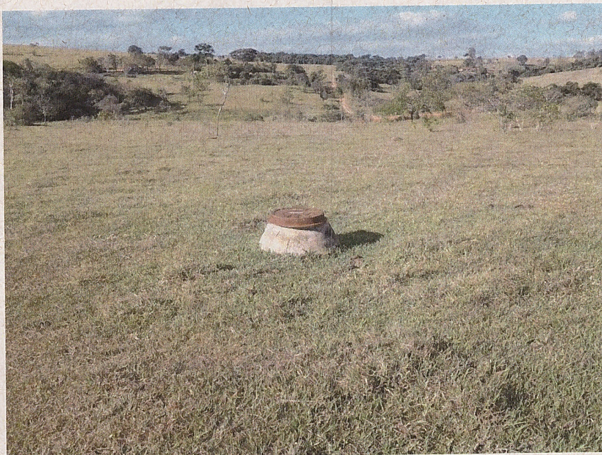
Poço de monitoramento da CETESB na área do aterro 3
