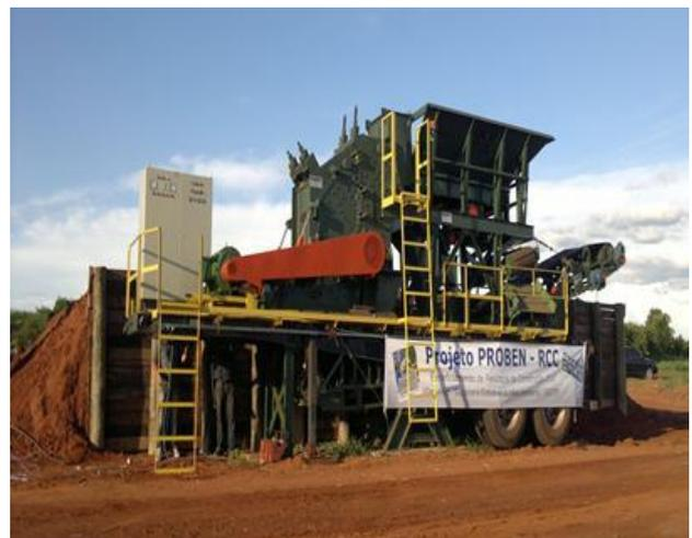
FIGURA 13: Equipamento de beneficiamento de resíduos da construção civil.
