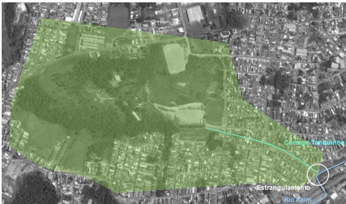
Figura 3.15 – Córrego Tanquinho, sua bacia de contribuição e ponto crítico de inundação no encontro com o Rio Itaim
