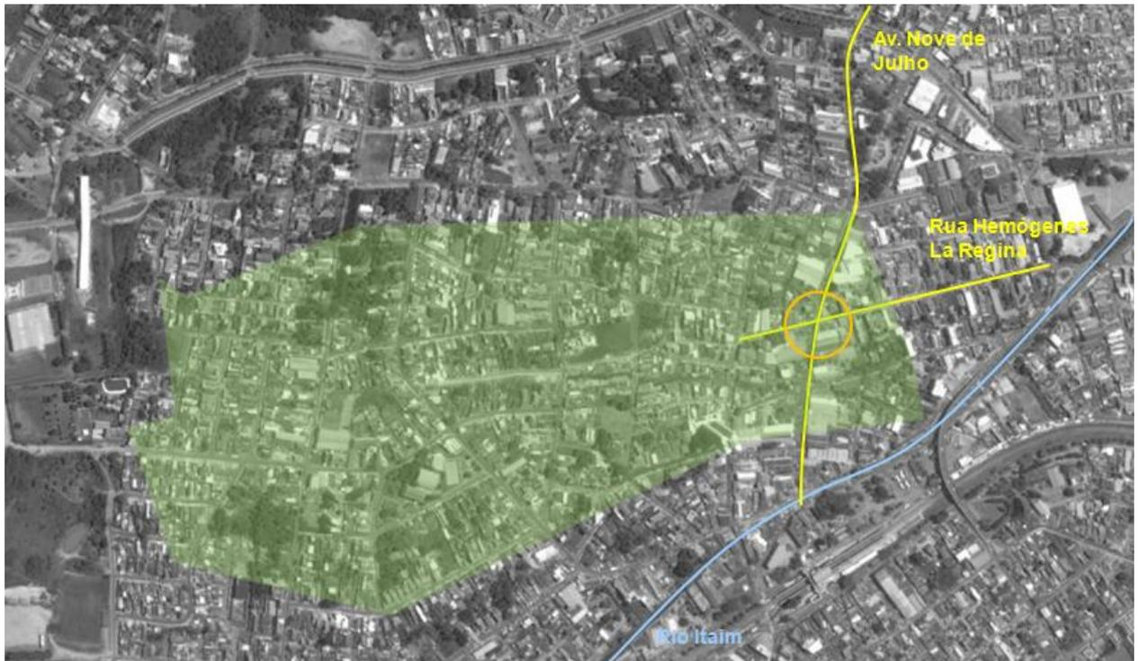
**Figura 3.16 – Córrego Vila Júlia (canalizado), sua bacia de contribuição e o ponto sujeito a inundações**
