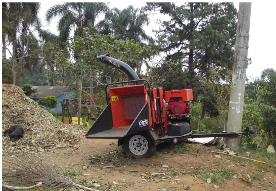
Figura 41 - Equipamento de trituração dos galhos e troncos de árvores para a diminuição do volume e manejo diferenciado dos resíduos de Poda e capinação, Julho/2014.
