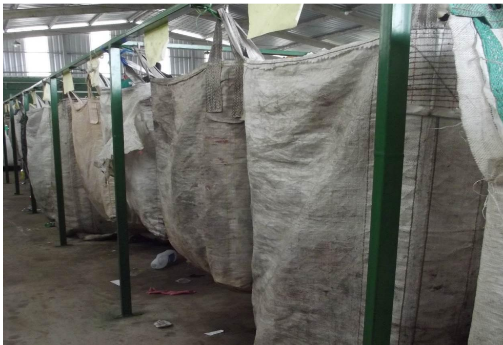
Figura 27 – Acondicionamento dos materiais já triados em bags em torno da esteira de triagem, Julho/2014.
