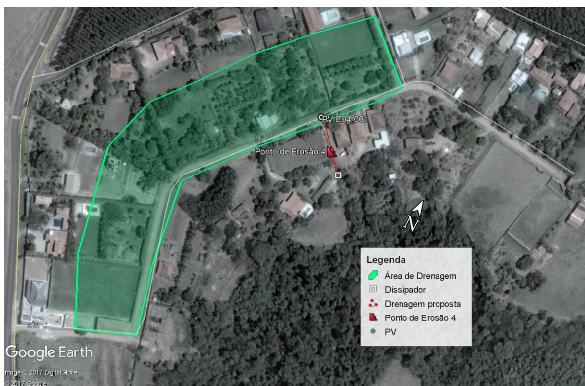
Ilustração 8.8 – Intervenções Propostas –Ponto de Erosão 4
