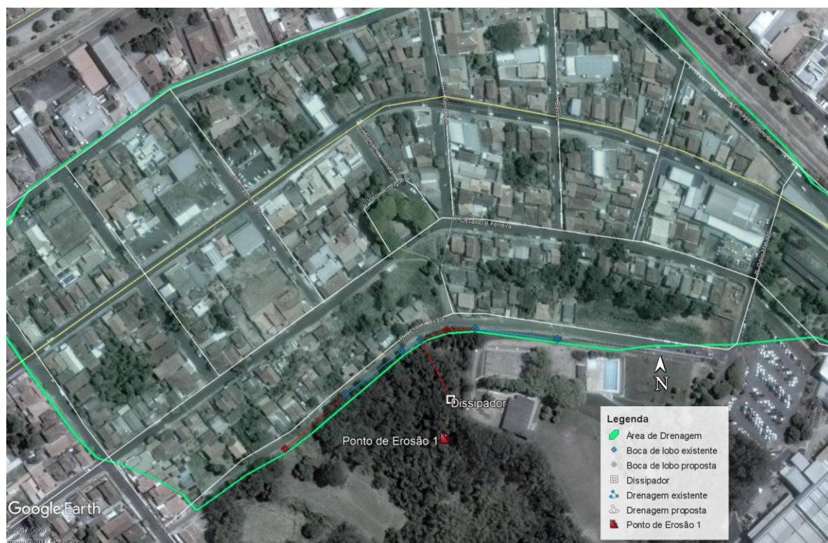
Ilustração 8.7 – Intervenções Propostas –Ponto de Erosão 1
