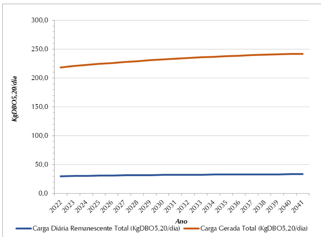
Figura 8.4 - Evolução de Cargas Orgânicas (Kg DBO 5,20 /Dia)
