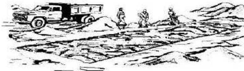
Assim que o primeiro trecho da vala estiver totalmente preenchido, passa-se para outro, repetindo-se as mesmas operações. O nivelamento final da vala deve ficar numa cota superior do terreno, prevendo-se prováveis recalques. (Figura 4).
