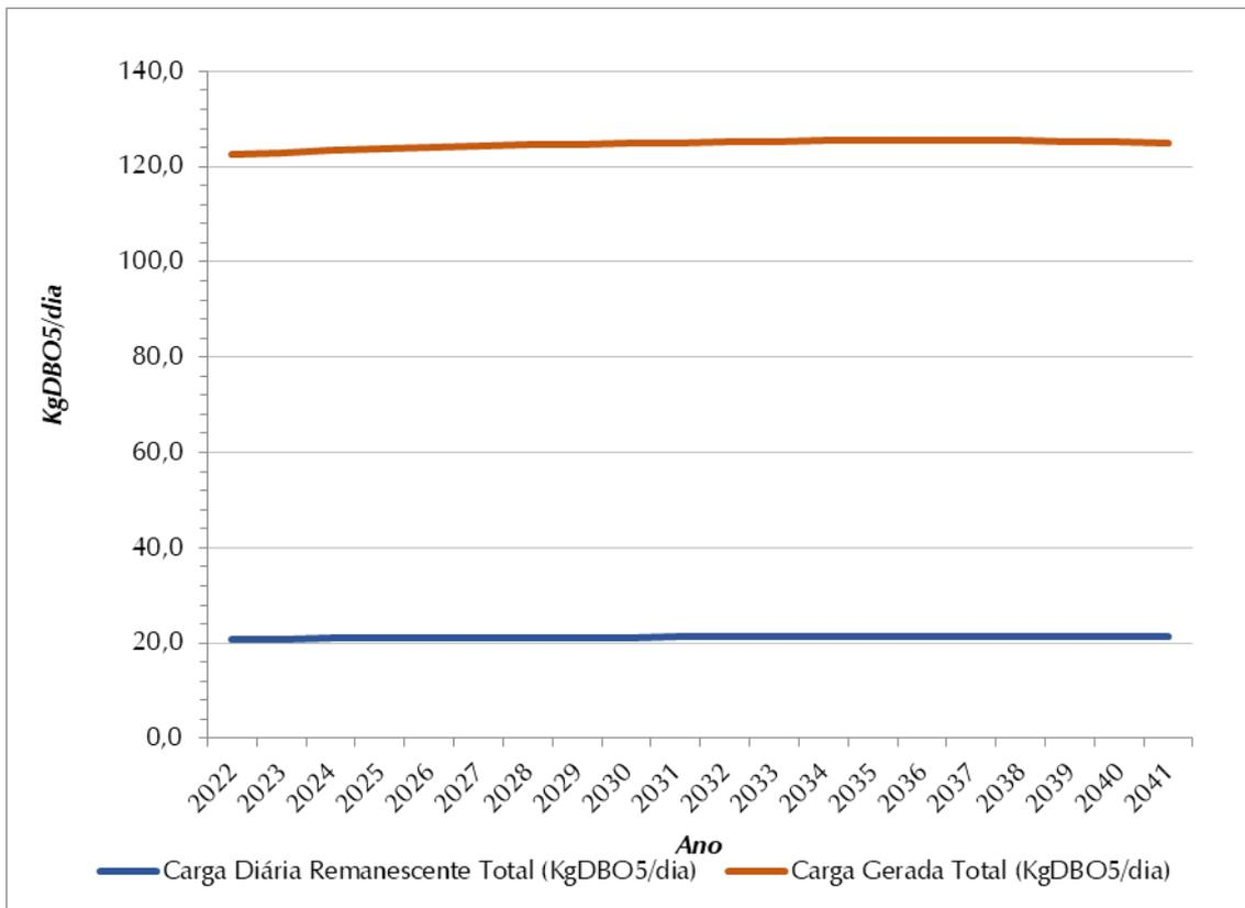
**Figura 8.4 - Evolução de Cargas Orgânicas (Kg DBO<sub>5,20</sub>/Dia)**
