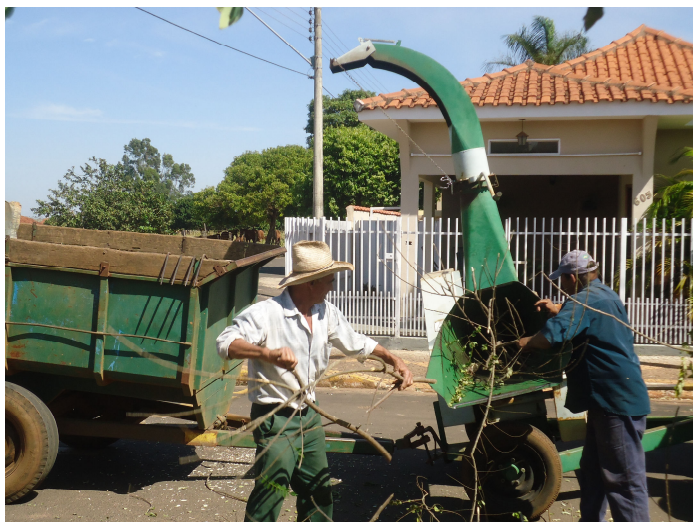
Figura 17 - Funcionários executando o serviço sem nenhuma proteção.
