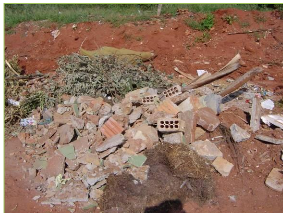
Foto 59: Resíduos de Construção e Demolição
