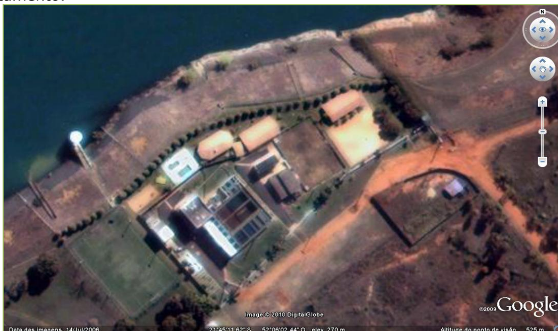
Imagem 03 - Vista geral do arranjo físico das unidades que compõem o processo de tratamento da ETA
