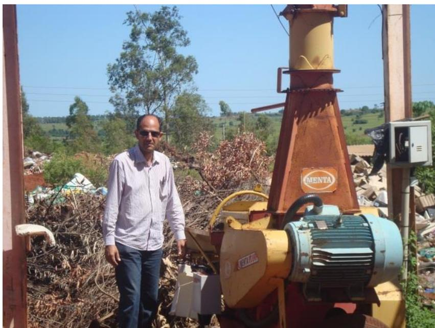
**Figura 30 - Máquina picadora de Galhadas.**
