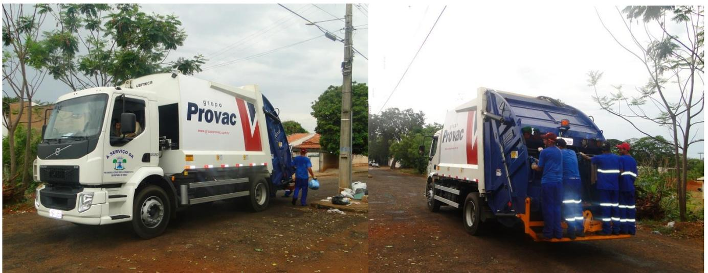
Figura 8 - Caminhão coletor compactador Volvo VM 220, alugado da empresa PROVAC.
