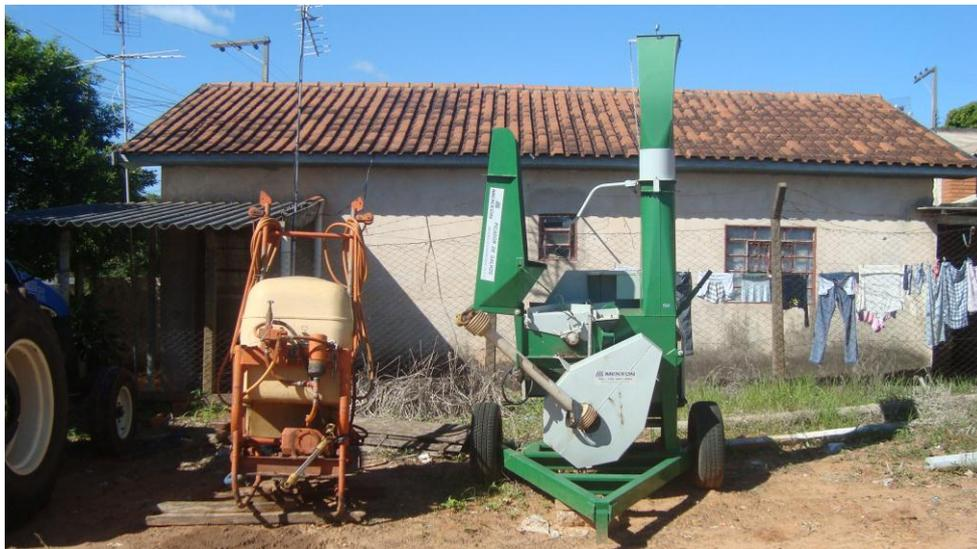
**Figura 39 - Maquina Trituradora de Galhadas e Bomba Pulverizadora de Defensivos Agrícolas.**
