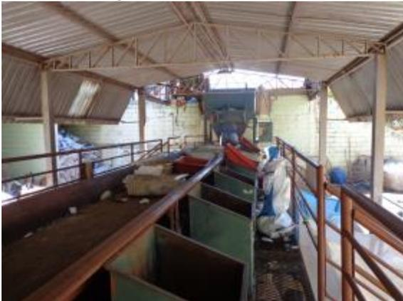
Figura 80- esteira de triagem de reciclados
