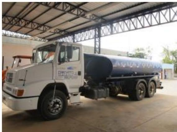
Figura 22- caminhão para transporte de água potável
