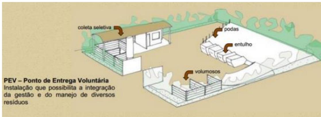
**Figura 54 - PEV – Ponto de Entrega Voluntária** Instalação que possibilita a integração da gestão e do manejo de diversos resíduos. Fonte Portal Resíduos Sólidos. <http://www.portalresiduossolidos.com/modelo-tecnologico-para-manejo-de-residuos-solidos/> (2014).
