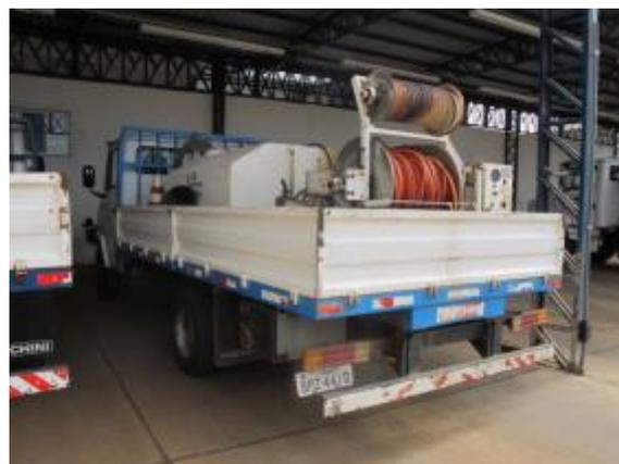
Figura 20 – Imagem de caminhão com equipamentos para esgoto
