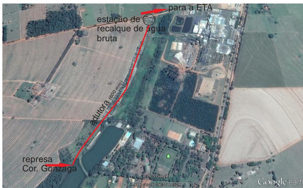
**Figura 27 – Imagem da represa de captação de água bruta junto ao Córrego Gonzaguinha**
