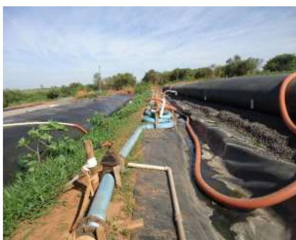
FIGURA 12: Ponto em que é adicionado o Floculante ao esgoto dragado.
