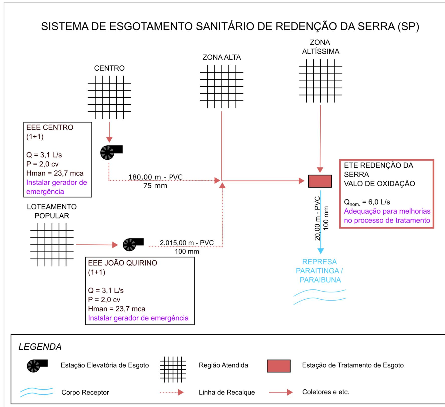
Figura 10.2 – Croqui do sistema de esgotamento sanitário proposto para Sede
