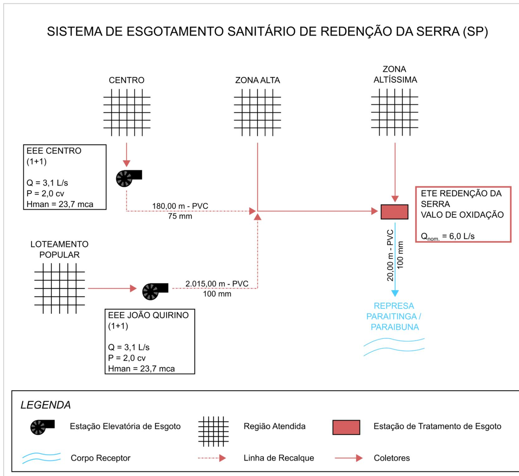
Figura 4.2 – Croqui do Sistema de Esgotamento Sanitário da Sede de Redenção da Serra.
