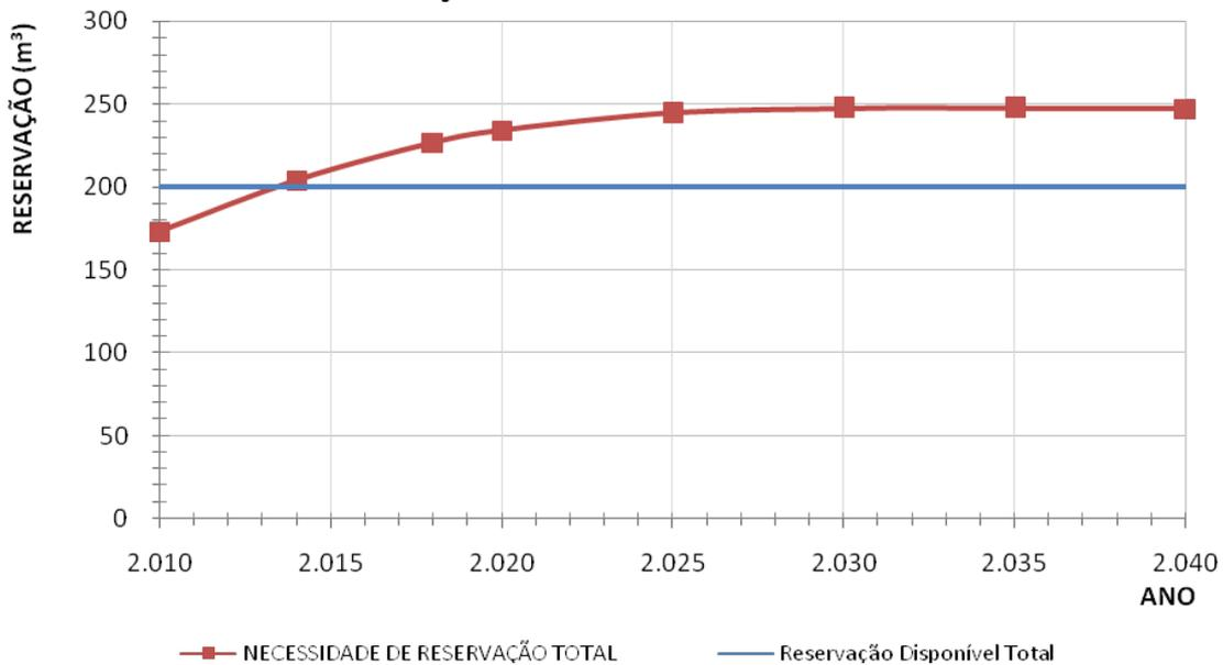
Pela projeção apresentada verifica-se que o sistema de reservação da sede urbana de **Redenção da Serra** não é suficiente para atendimento à demanda estimada até o final de plano. Propõe-se a implantação de um reservatório com capacidade de 50 m<sup>3</sup> no início de plano, suficiente para atendimento até o final de plano.
