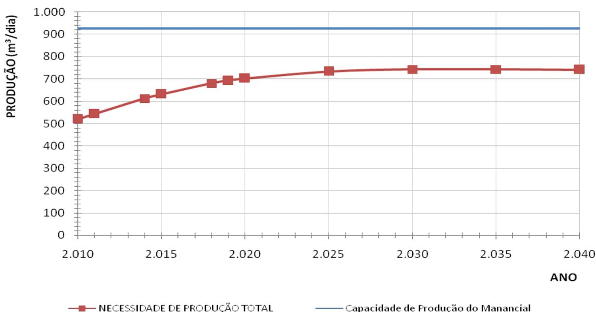
A projeção elaborada indica que não haverá déficit na produção até o final do período de planejamento, ou seja, 2040. Portanto, com relação à vazão de captação do manancial, não serão necessárias intervenções para aumento da vazão captada.
