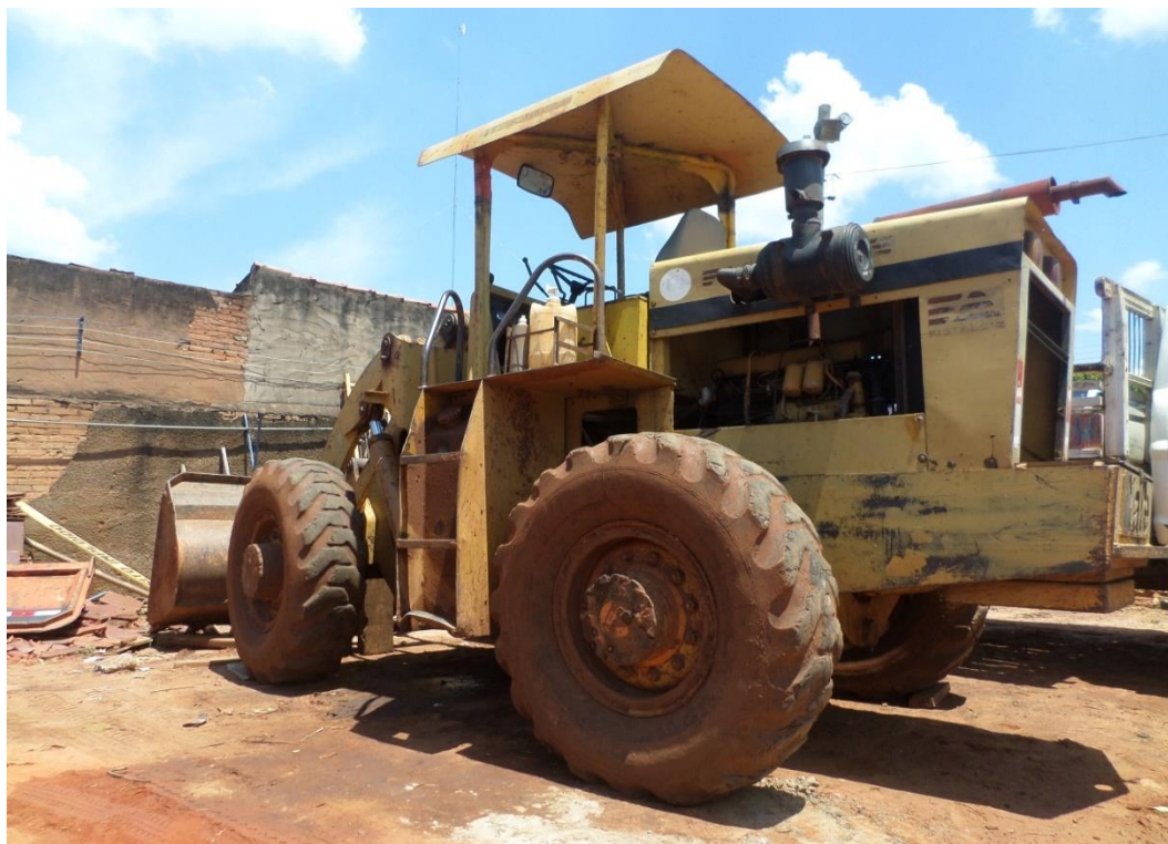
Imagem 44 - Pá-carregadeira usada no aterro em valas
