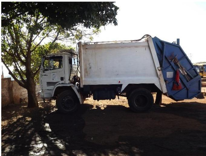
Foto 3.1 – Vista do caminhão coletor compactador utilizado na coleta regular
