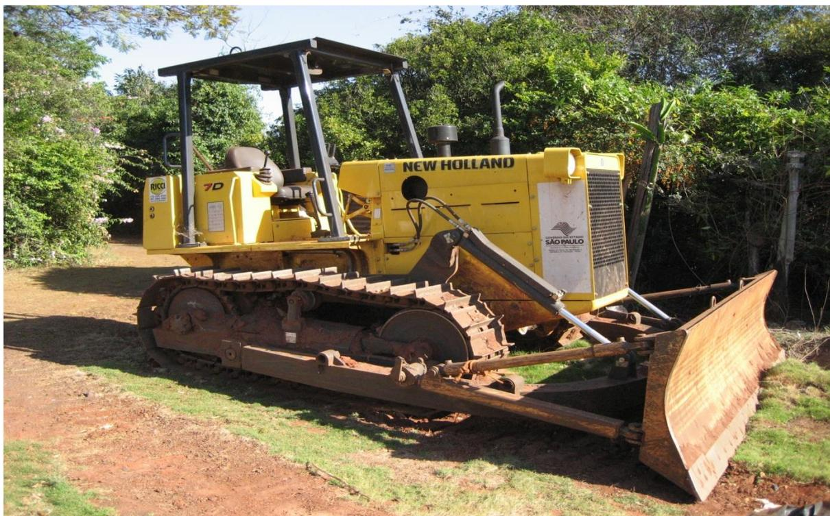
Figura 12: Esteira Trator New Holland modelo 7D
