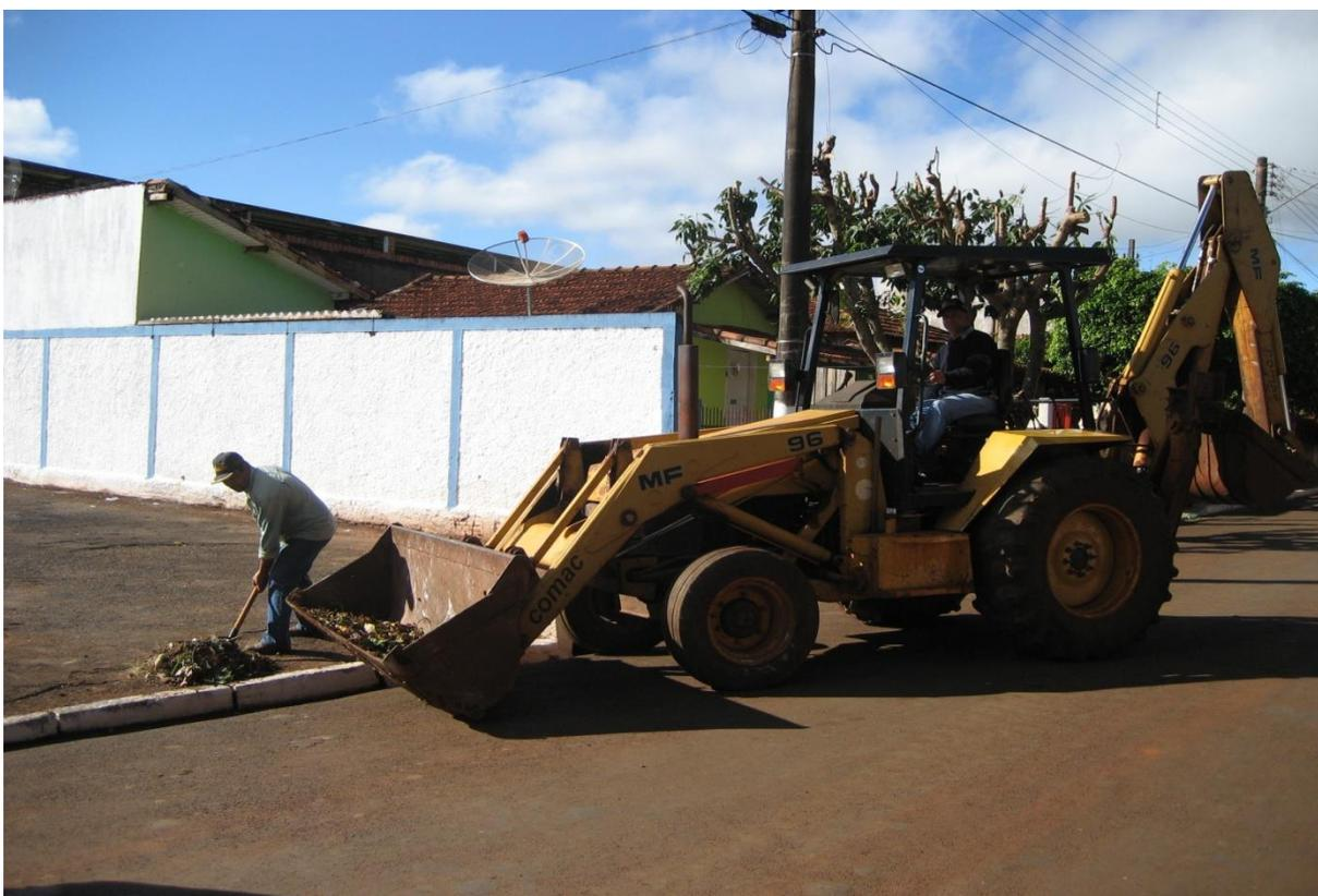
Figura 19: Retroescavadeira Massey Ferguson modelo Mf 96
