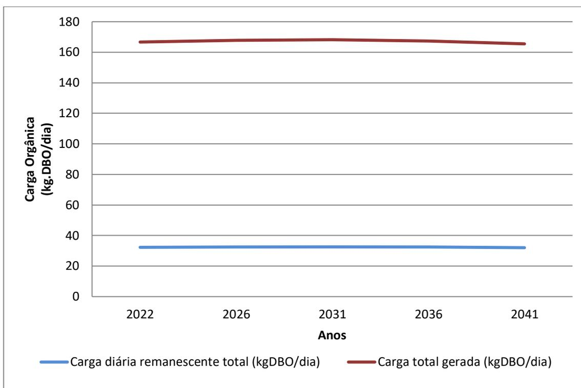
**Gráfico 8.4 - Evolução de Cargas Orgânicas (Kg DBO<sub>5,20</sub>/Dia)**
