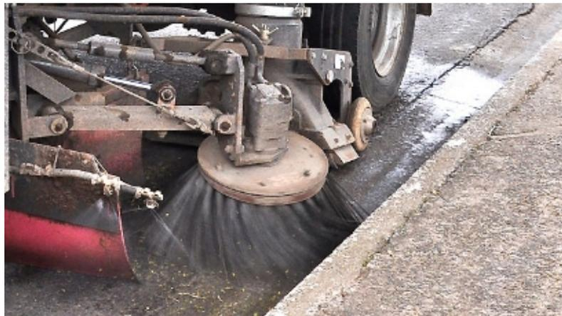
Figura 11.2.1. Varredeira Mecânica
