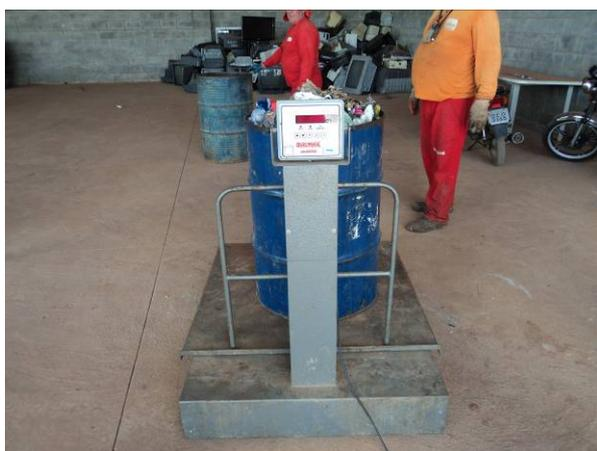
Figura 11.1.1.17. Tambor com massa de resíduos homogênea sendo pesado para depois serem separados todos os materiais
