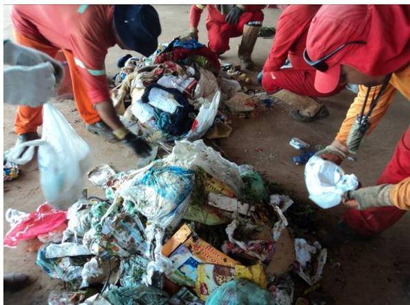
Figura 11.1.1.30. Início da separação da amostra por materiais
