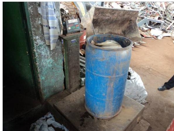
Figura 11.1.1.39. Pesagem total de amostra homogênea escolhida para ser caracterizada
