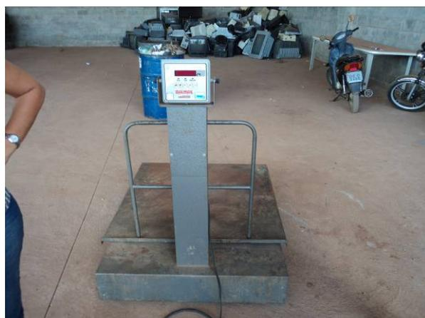
Figura 11.1.1.4. Balança de piso utilizada nas gravimetrias
