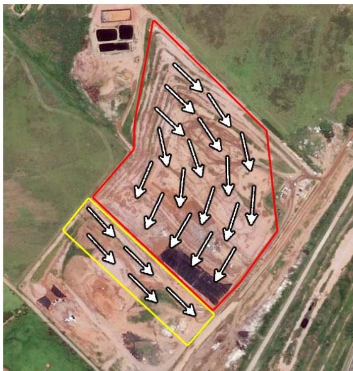
Figura 11.1.1.73 Sentido de avanço da frente de trabalho nas duas células, encerrada e em operação
