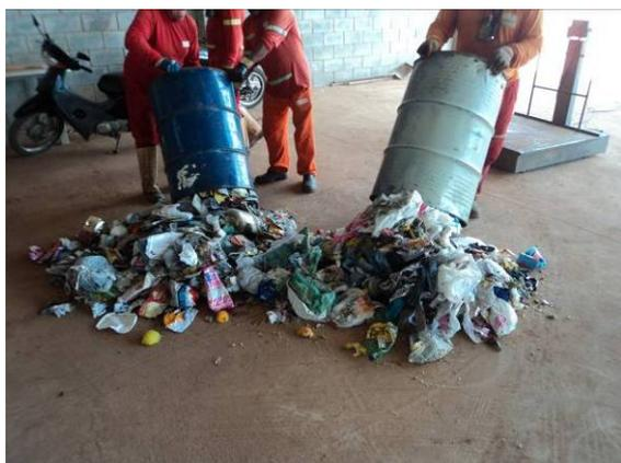
Figura 11.1.1.19 Amostra de resíduos a serem separadas por material
