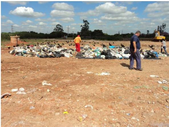
Figura 11.1.1.12. Início do procedimento de quarteamento com separação manual
