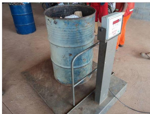
Figura 11.1.1.18. Tambor com massa de resíduos homogênea sendo pesado para depois serem separados todos os materiais
