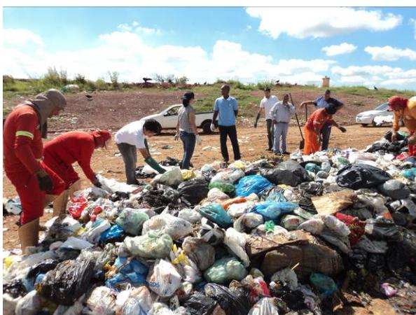
Figura 11.1.1.14. Homogeneização dos resíduos a partir da rasgagem dos sacos plásticos
