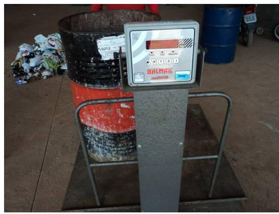
Figura 11.1.1.29. Pesagem total de amostra homogênea escolhida para ser caracterizada
