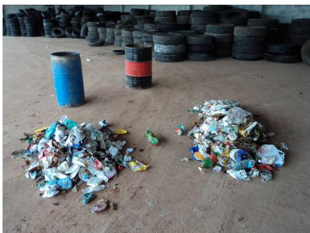
Figura 11.1.1.40. Início da separação da amostra por materiais
