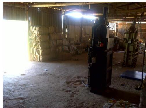
FOTO 4.23: PRENSA E BALANÇA DO GALPÃO
