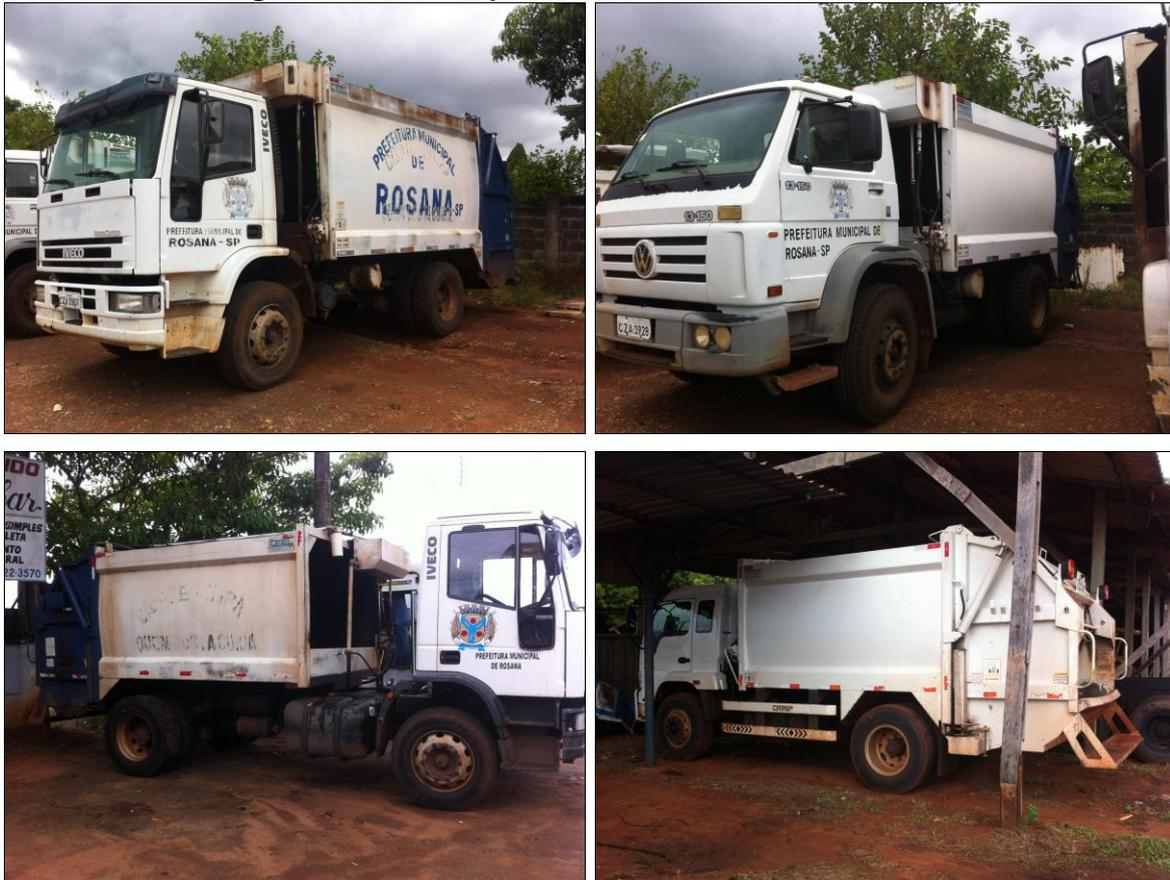
Os veículos coletores são equipados com dispositivos de compactação mecânica com plataforma de carregamento traseira e basculamento mecânico à descarga. Através de prensa hidráulica, os resíduos sólidos são compactados no interior do compartimento de carga, de forma a reduzir seu volume.
