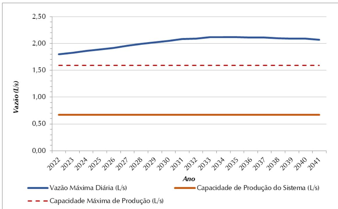
Figura 8.3 – Demandas Máximas Diárias (L/s) X Vazão Captada (L/s) – SAA Caramuru
