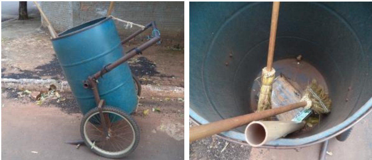
Figura 101. Equipamentos utilizados para varrição
