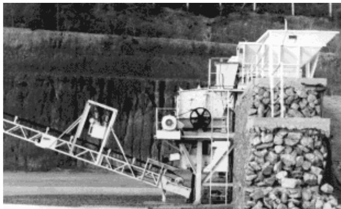
Usina de Reciclagem de entulho de B.H. Alimentador e triturador
