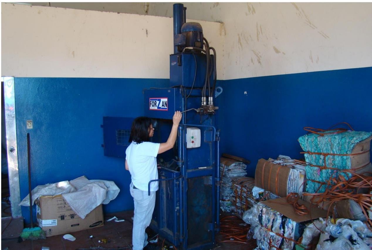
Imagem 32: Modelo de prensa para compactação e enfiamento dos materiais recicláveis após sua separação.
