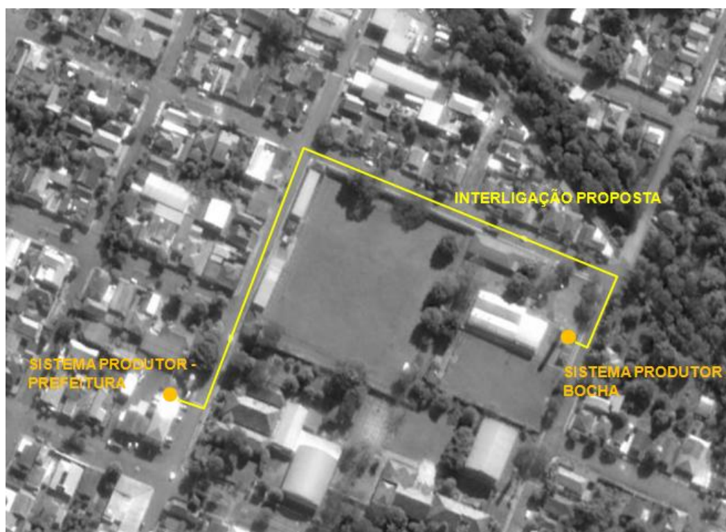
Figura 8.1 – Solução proposta para a interligação entre os sistemas produtores da Prefeitura e do Bocha
