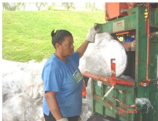
**Figura 59 - Banca de triagem e prensa.**
