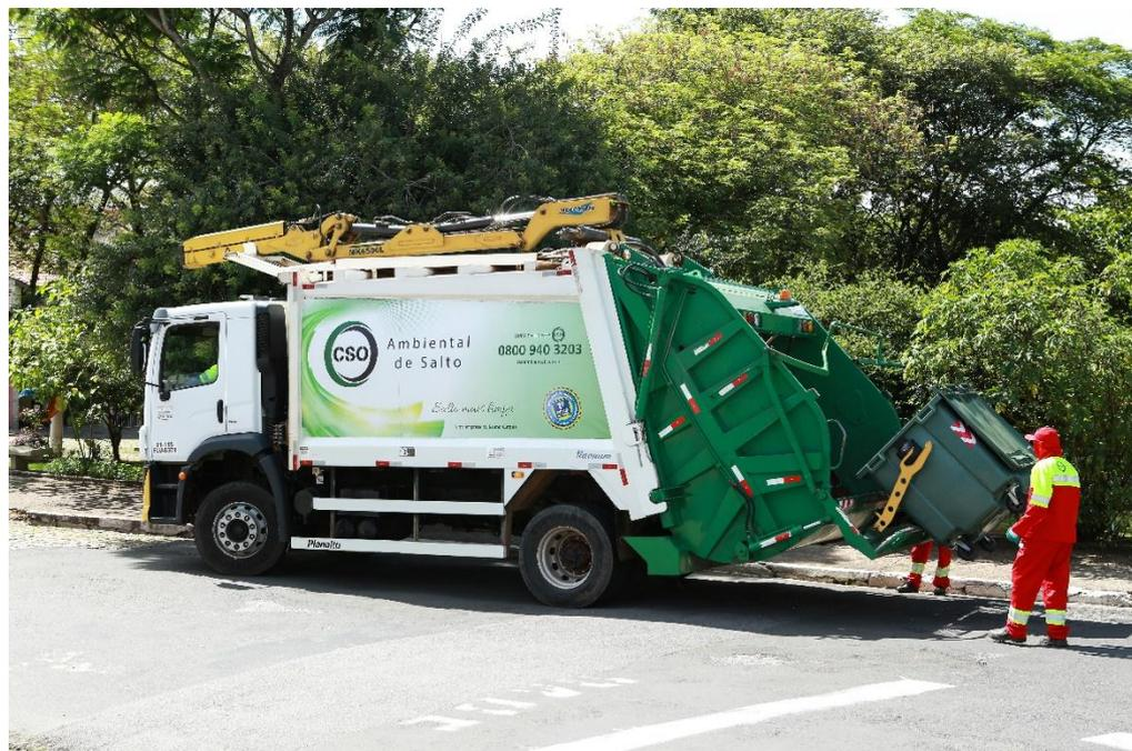
**Figura 27- Coleta mecanizada**
