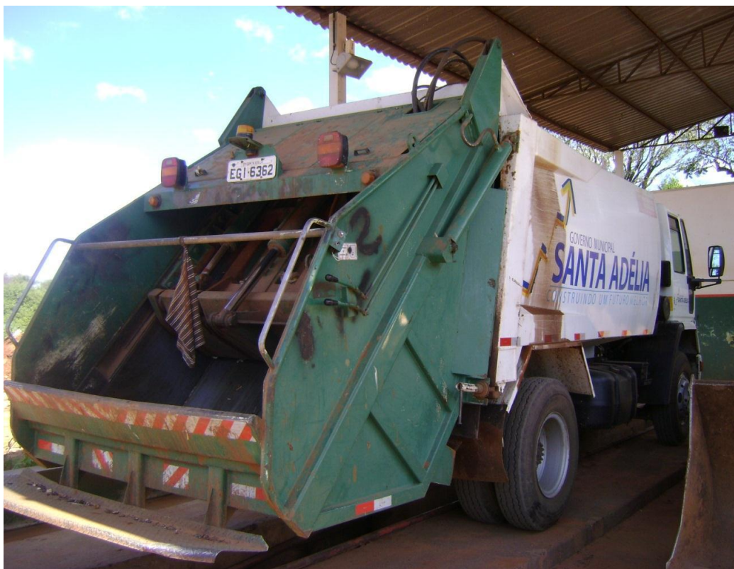
Figura 10 – Detalhe da caixa compactadora do caminhão coletor compactador de lixo
