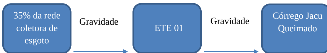
Fluxograma 1 – Percurso do esgoto encaminhado para a ETE 01
