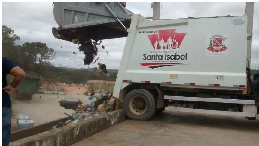
Figura 47: Transferência dos resíduos do caminhão coletor.
