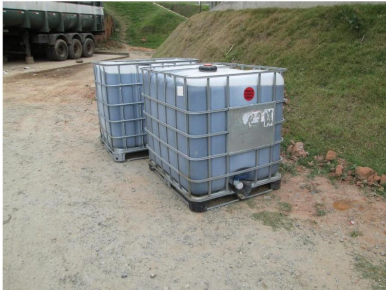
Figura 49: Chorume condicionado para transporte para estação de tratamento.
