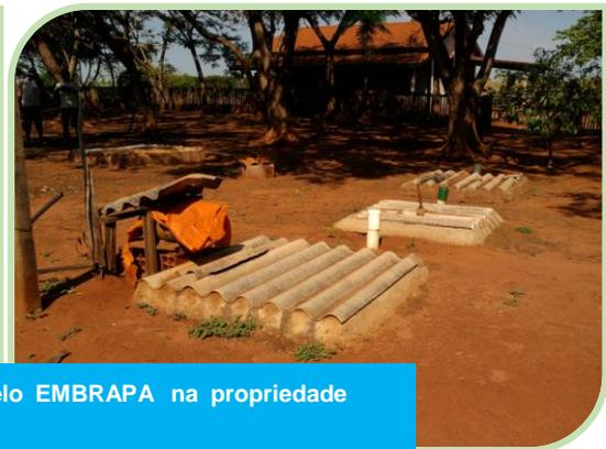
IMAGEM 10.: Biodigestores anaeróbios, modelo EMBRAPA na propriedade rural "Três Marias", Santa Mercedes.
