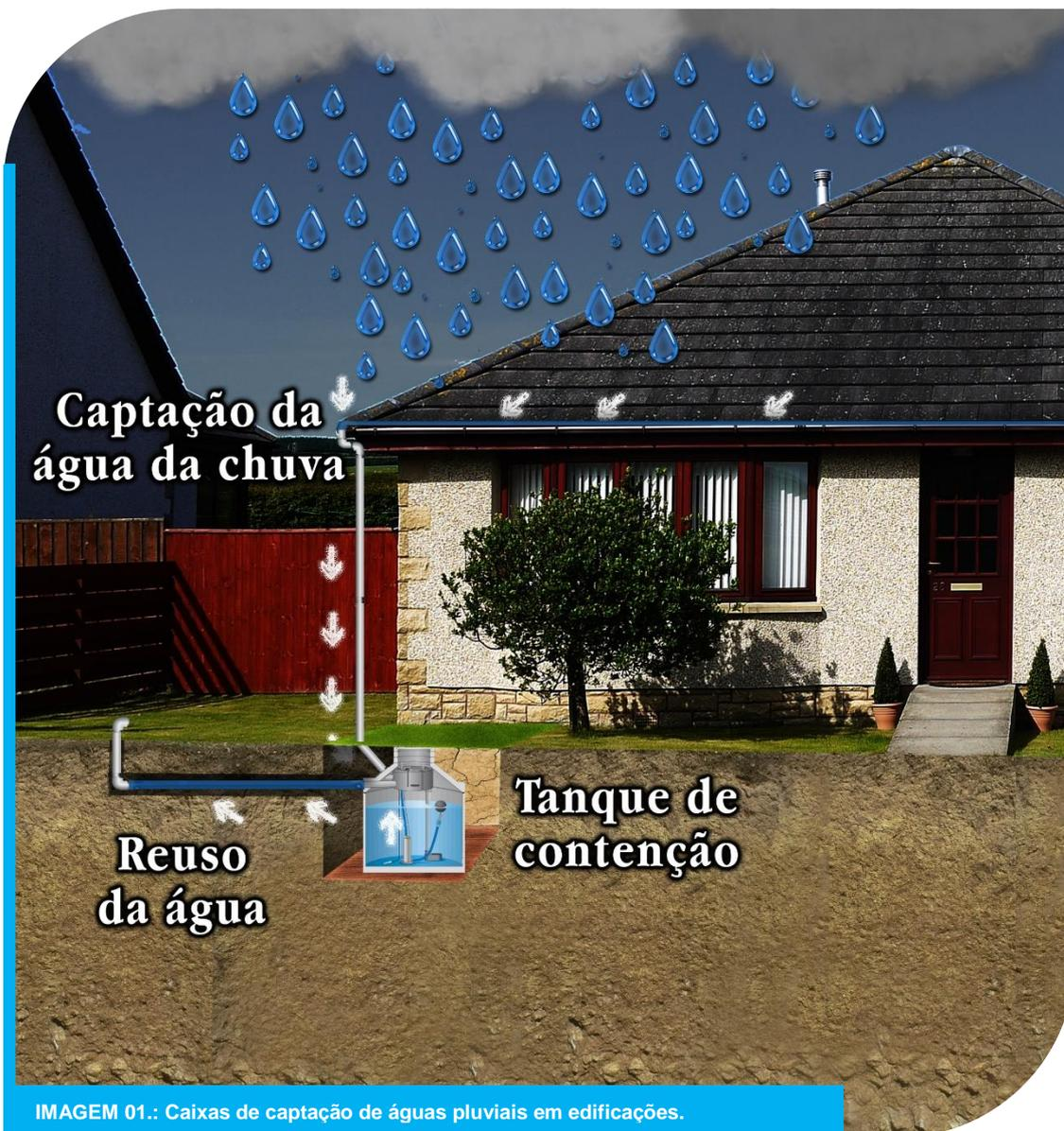
Como exemplo, apresentaremos uma estimativa de cálculo para uma residência com 100,00 m<sup>2</sup> de telhado e a quantidade de água que cai sobre este telhado com uma chuva de 20mm/h (intensidade de chuva), durante 10 minutos.
