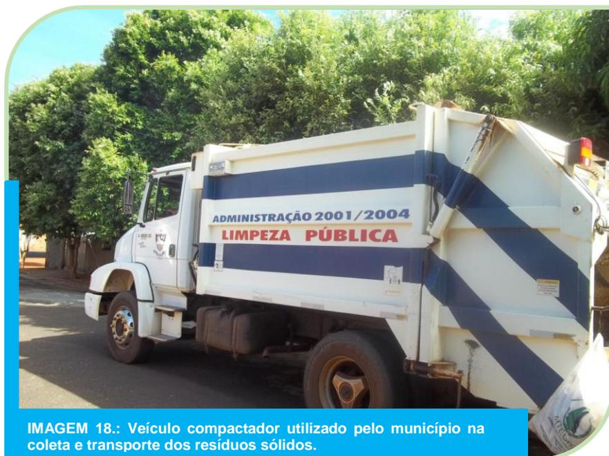
IMAGEM 18.: Veículo compactador utilizado pelo município na coleta e transporte dos resíduos sólidos.
