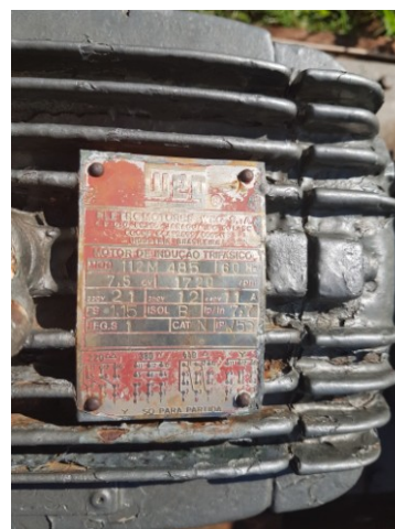
Foto 3.6 – Placa de Especificações técnicas
