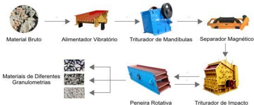
Figura 21 - Esquema de uma usina de reciclagem de RCC's.
