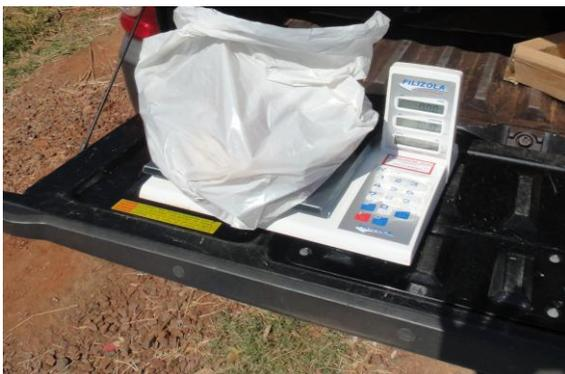
Toda porção separada dos componentes desejados foram acondicionados em saco plástico leitoso de 40 litros com tara de 26 gramas, inclusive os materiais que não se encontravam na listagem de componentes pré-selecionados;
