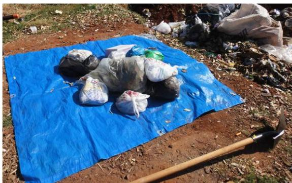
O montante foi dividido em quatro partes iguais, descartando-se 2 partes e selecionando-se 2 quartos (opostos) que foram novamente homogeneizados;
