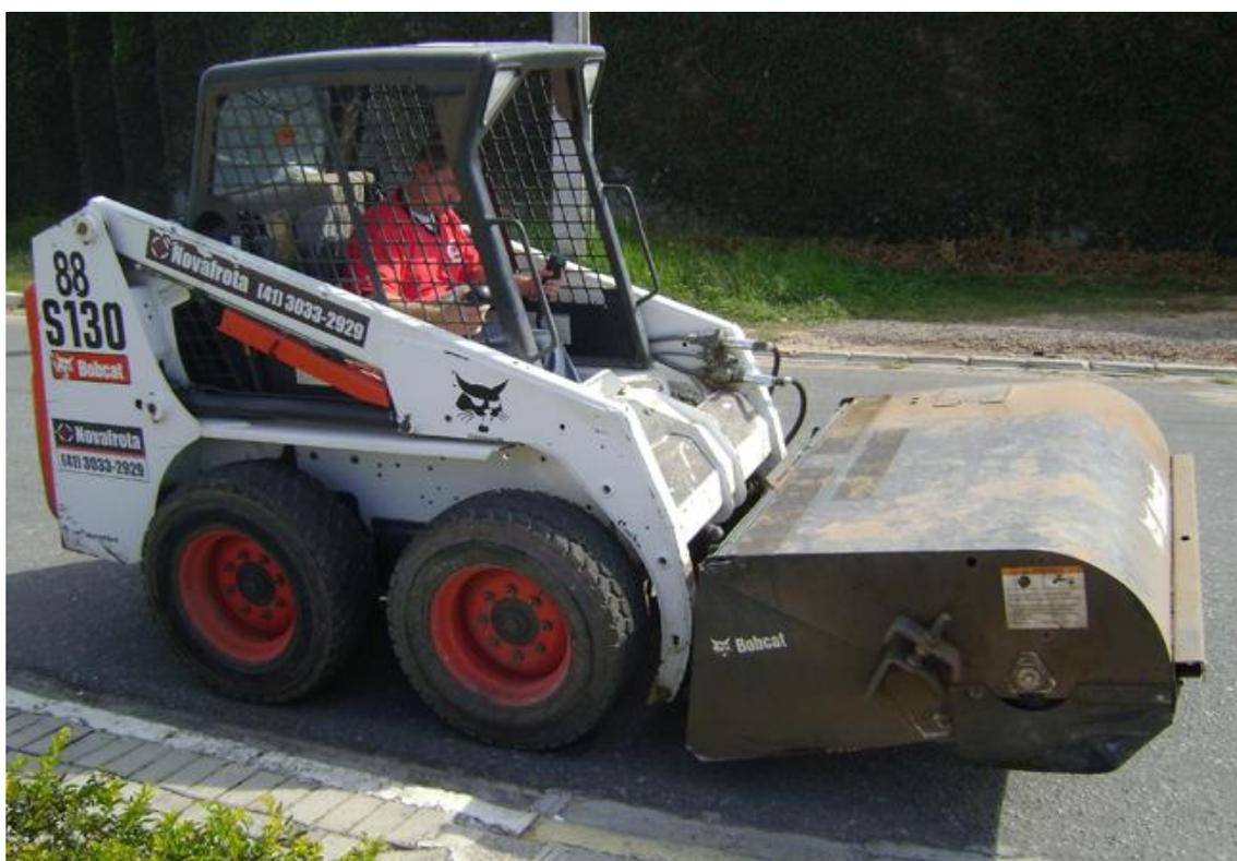
Figura 3 - Varredor mecanizado
