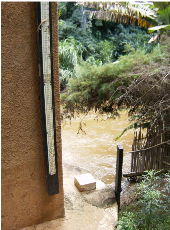
Foto 3.1-1: Régua limnimétrica sob a ponte da Av. Vereador Sebastião Ferreira
