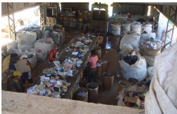
Foto 4.24 - Galpão de reciclagem e esteira e triagem Fonte: Plano de gerenciamento Integrado dos Resíduos Sólidos - 2010
