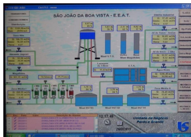
Foto 4.10 - Tela de monitoramento do sistema de abastecimento em tempo real
