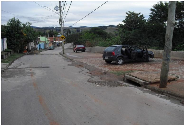
**Foto 12 – Boca de lobo responsável pela coleta das águas pluviais que escoam pelas sarjetas.**
