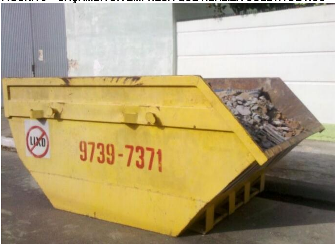
FIGURA 8 – CAÇAMBA DA EMPRESA QUE REALIZA COLETA DE RCC
