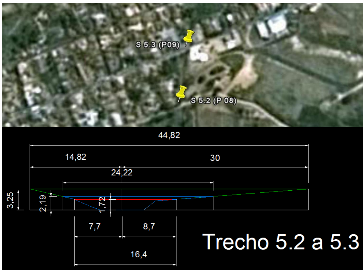
Figura 86: Trecho 5.2 a 5.3 - Vista aérea e detalhamento do canal
