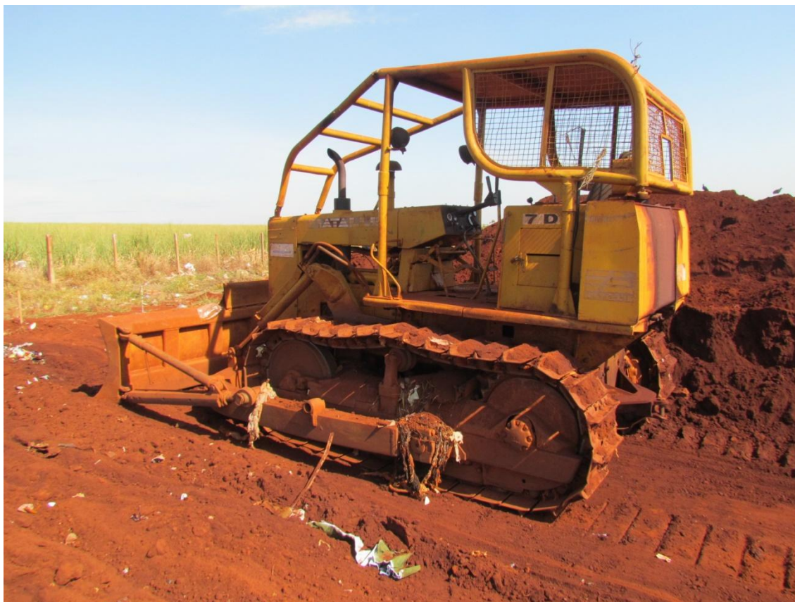
Figura 41 - Maquinário utilizado para colocar camadas de terra sobre o lixo depositado.
