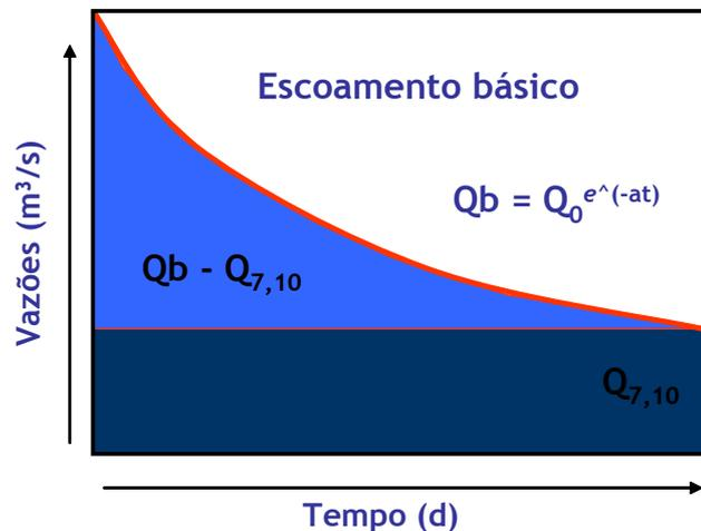
**Figura 4.1 - Representação Esquemática da Hidrógrafa de Escoamento Básico, com Separação das Vazões Mínimas (Q<sub>7,10</sub>) e Reservas Ativas (Qb-Q<sub>7,10</sub>)**
