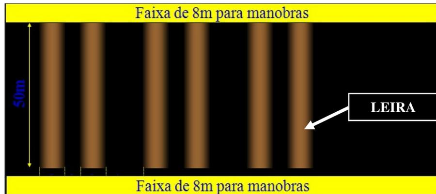
**Figura 86.** Dimensionamento de pátio para compostagem. Fonte: Kiehl (2010).
