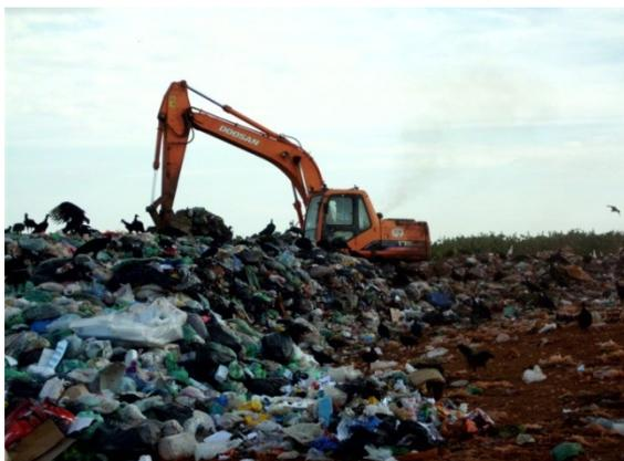
**Figura 43.** Operação no transbordo com escavadeira hidráulica.
