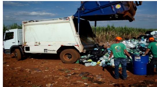
**Figura 47.** Caminhão coletor-compactor.
