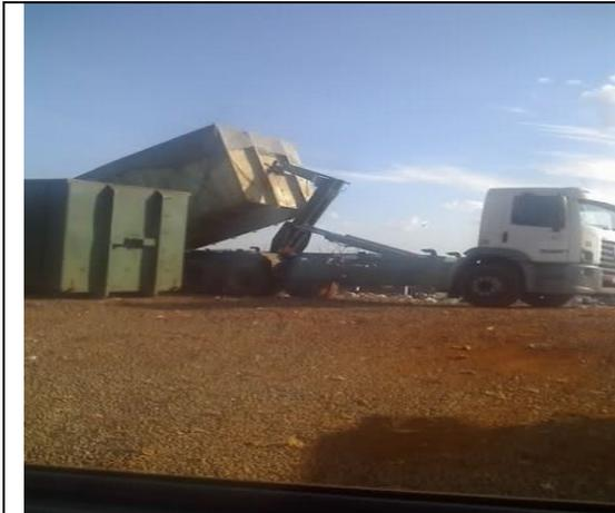
**Figura 22.** Carreta basculando contêiner com resíduos na Estação de Transbordo Provisória de Sertãozinho
